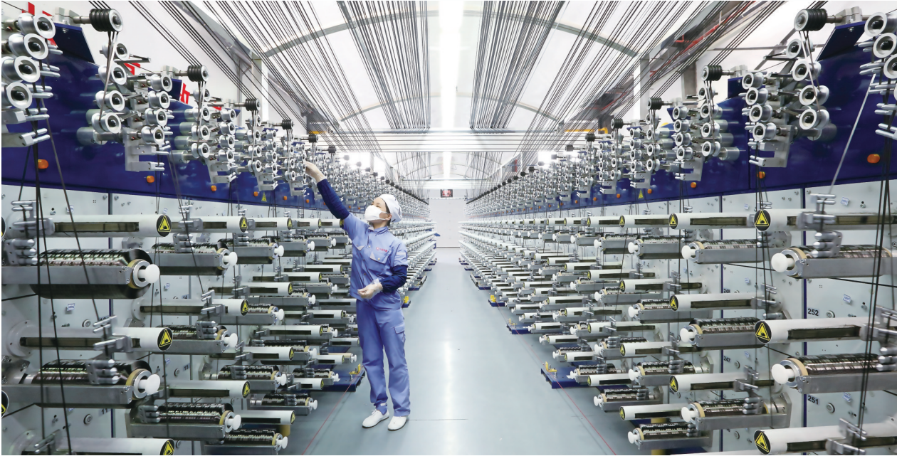
中国建材西宁万吨碳纤维生产基地的车间,工人正在检查智能化生产线卷绕情况
