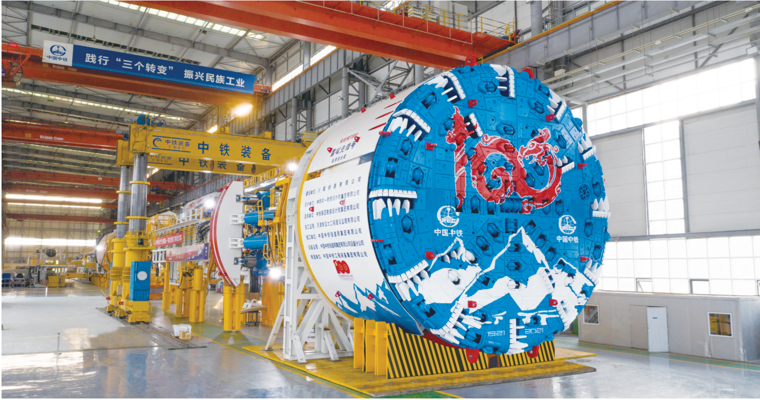
国产首台高原高寒大直径硬岩掘进机在郑州下线
